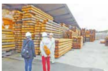
伐り出された木は、工場に運ばれ、様々なサイズに加工されて、人工乾燥機に入れた後に、ひび割れ、反り、歪みなどが出たところをチェックします。(強度試験を全数しています)
