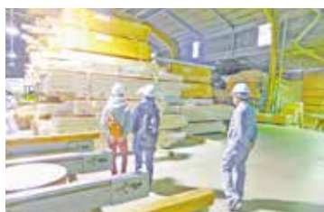
最終加工(プレカット)材として加工機に入れられた木材は、一部一部を梱包してストックされます。一ヶ月に50部から60部ほどの生産がされて、出荷されていきます。
